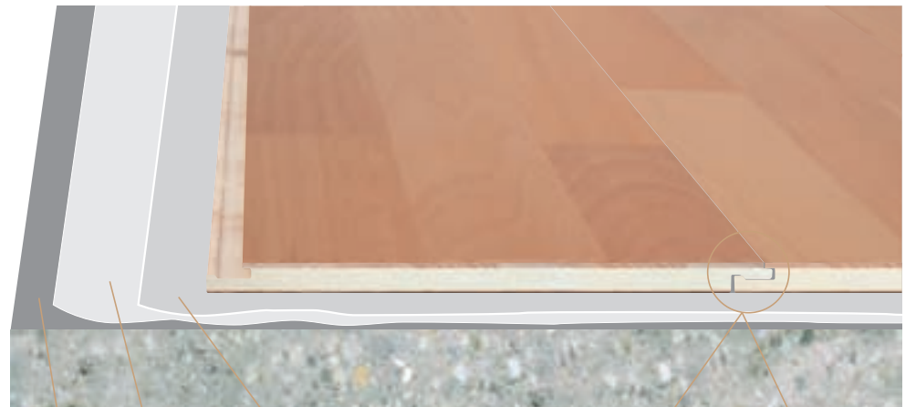
Estrich PE-Folie 0,2 cm Trittschalldämmung PE-Schaum, Kork etc. Lockverbindung (G2) bei Schiffsboden auf Anfrage lieferbar. Nut- und Federverbindung
